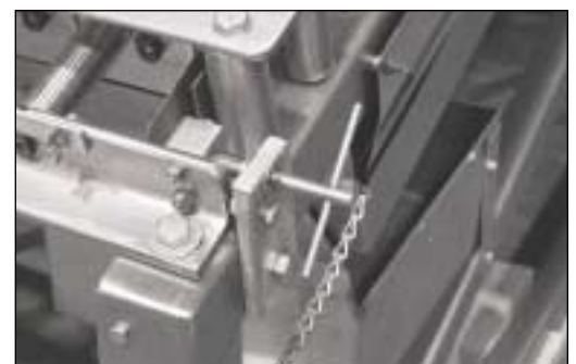
La manivela de ajuste permite ajustar los rodillos con rapidez y facilidad para una operación más eficiente.
