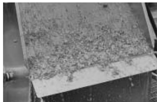
Un cedazo separa los sólidos del agua.
