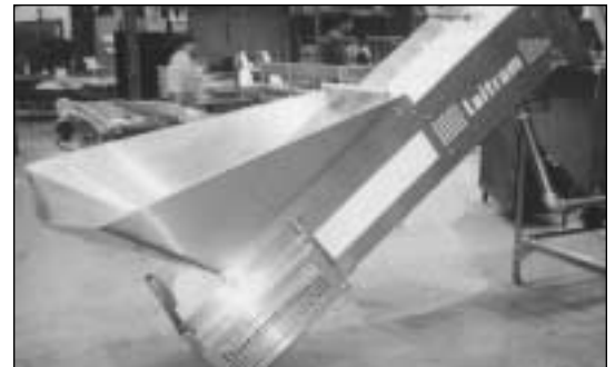
La descarga de los camarones en la tolva alimentadora de la banda transportadora, es la única operación manual requerida.
