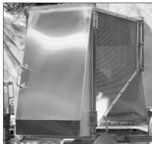
El recolector de desperdicios puede ser instalado a la izquierda o a la derecha del separador de acuerdo a las necesidades de espacio en su planta.
